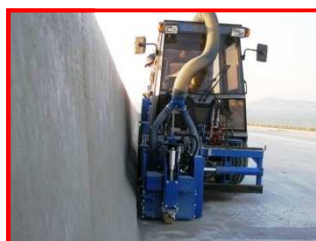
System regulacji nachylenia głowicy frezującej
