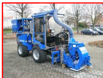
2x11kW silniki hydrauliczne do śrutownic
