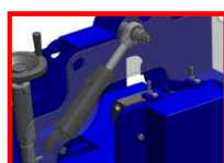
System regulacji nachylenia głowicy frezującej
